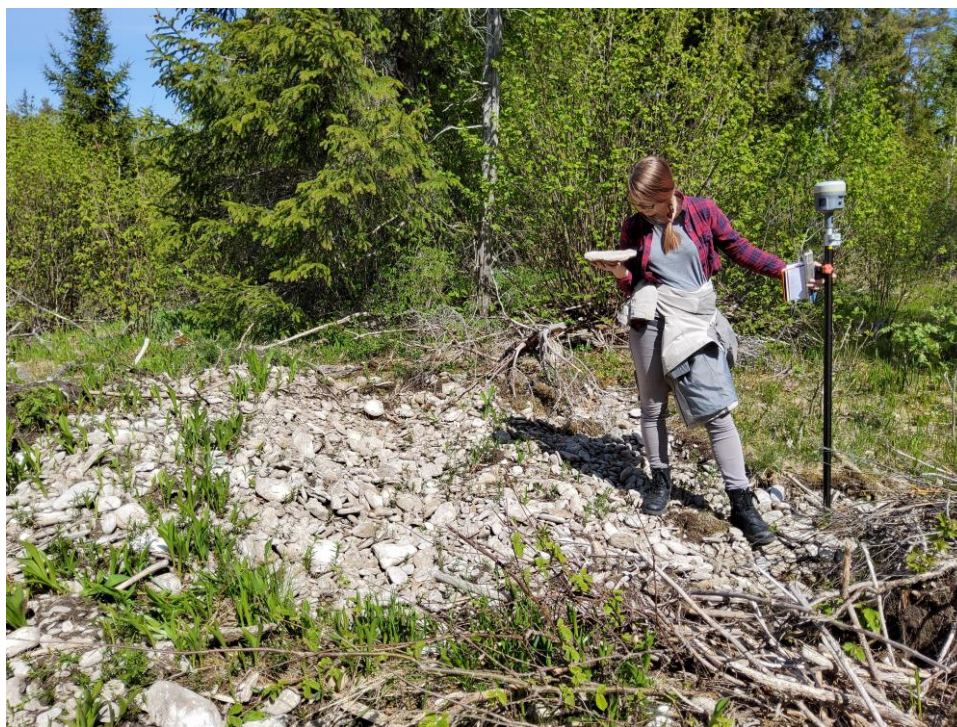
Joonis 9. Autor punkti mõõtmishetkel Trimble R10 GNSS vastuvõtjaga Varbolas.
