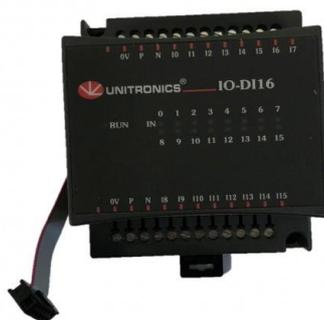
Рис. 2.3 IO-DI16 Модуль дискретного ввода[9]
