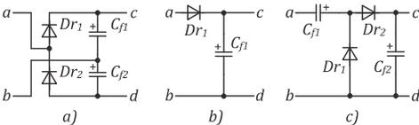
Fig. 3. Rectifiers selected for comparison: a) VDR1, b) HWR, c) VDR2.
