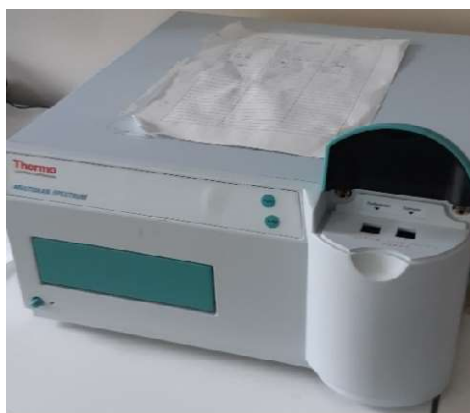
Joonis 5. Ultraviolett ja nähtava valguse spektrofotomeeter Multiskan Spectrum (ThermoFisher Scientific, USA).
