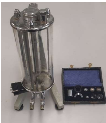
Joonis 2. Langeva kuuli viskosimeeter e Höppleri viskosimeeter.
