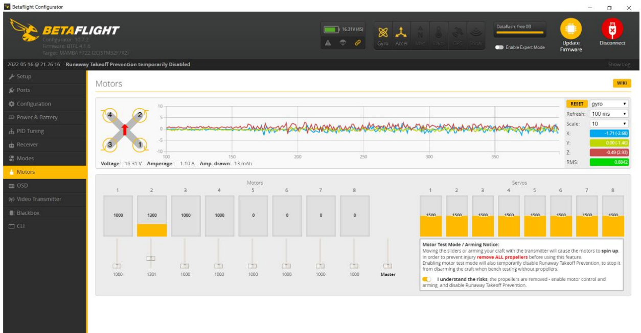
Joonis 2.1.7 Betaflight tarkvara, kus 1 mootor teeb tööd 30% võimsusel. [25]
