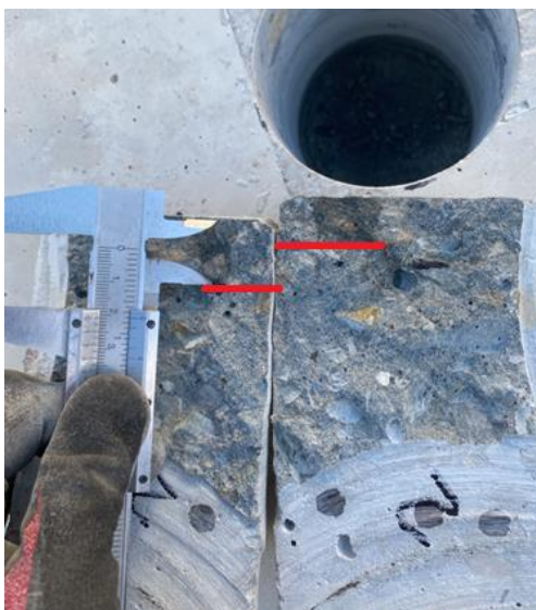
Foto 2.4.2.4: Katsekeha 2 välja puuritud proovikeha (poolitatud) [autori erakogu]
