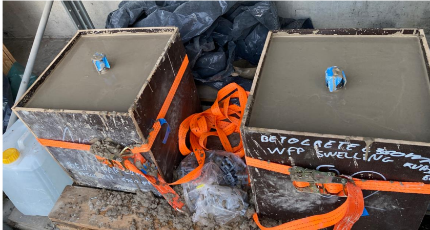
Foto 2.2.2.5: Värskest betoneeritud katsekehad 8 ja 10 [autori erakogu]
