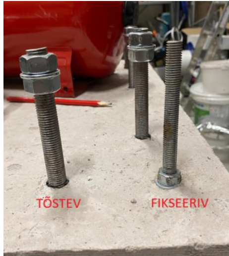
Foto 2.3.4.1: Katsekeha 11 tõstemehhanismi keermelatid [autori erakogu]
