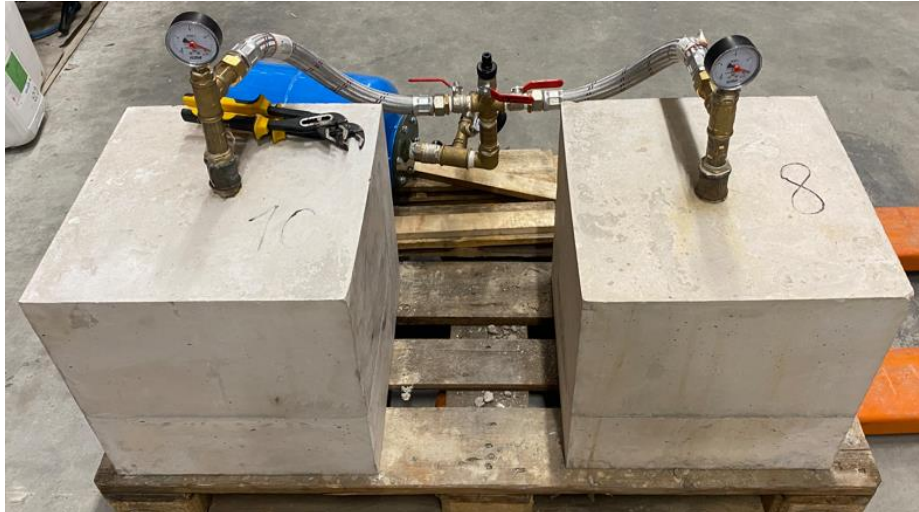
Foto 2.3.3.3: Katsekehad 8 ja 10 katsetamisel (23.11.2024 15 bar) [autori erakogu]
