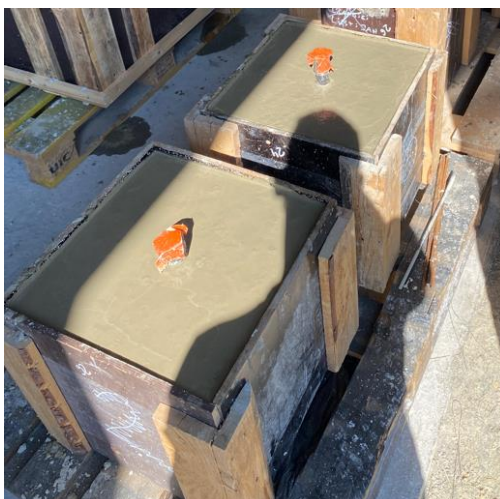
Foto 2.2.2.4: Värskest betoneeritud katsekehad 7 ja 9 [autori erakogu]
