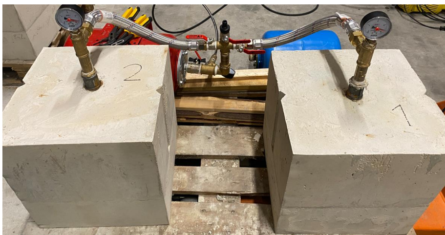
Foto 2.3.2.1: Katsekehad 1 ja 2 katsetamisel (22.10.24 15 bar) [autori erakogu]
