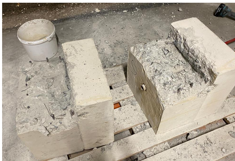
Foto 2.3.2.3: Katsekehade 3 ja 6 lammutatud küljed (09.11.24) [autori erakogu]
