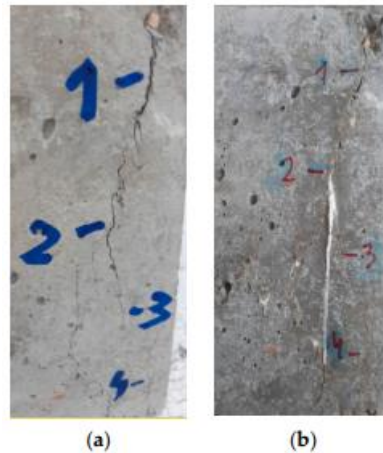
Foto 1.1.4.1: Pragu katsekehas enne (a) ja pärast (b) "kinni kasvamist" [15]
