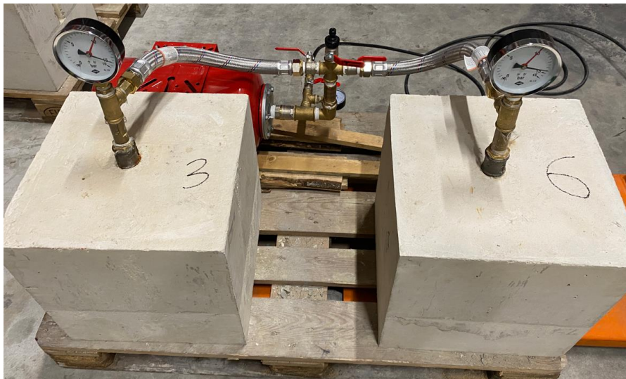
Foto 2.3.2.2: Katsekehad 3 ja 6 katsetamisel (22.10.24 15 bar, joogivesi) [autori erakogu]
