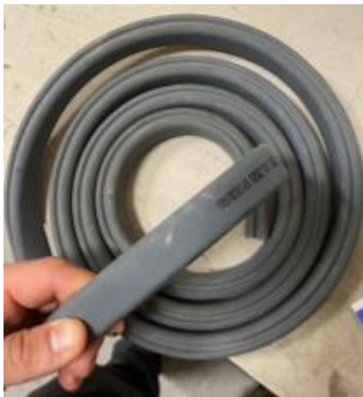
Foto 2.1.1.6: WFP Swelling Rubber Profile sünteetilisest kummissesgust lint[autori erakogu]
