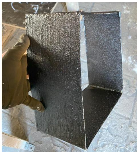
Foto 2.1.1.1: WPM bituumenkattega töövuugiprofiil [autori erakogu]
