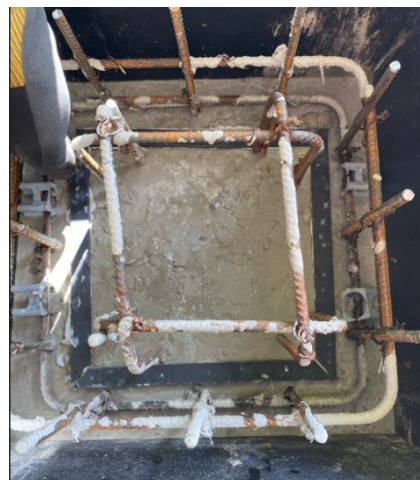
Foto 2.2.1.4: Katsekeha 9 vuugilindi paigaldus [autori erakogu]
