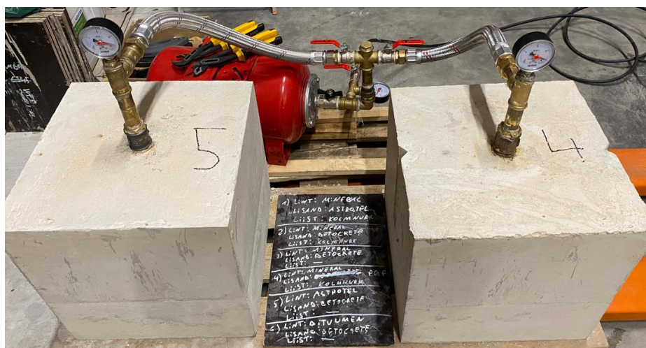
Foto 2.3.2.4: Katsekehad 4 ja 5 katsetamisel (22.10.24 15 bar, joogivesi) [autori erakogu]
