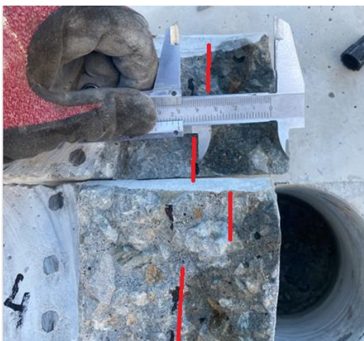
Foto 2.4.2.8: Katsekeha 4 välja puuritud proovikeha (poolitatud) [autori erakogu]
