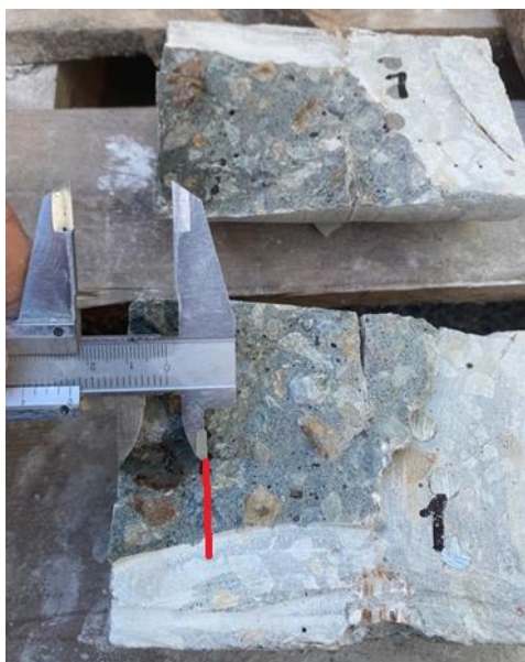
Foto 2.4.2.2: Katsekeha 1 välja puuritud proovikeha (poolitatud) [autori erakogu]
