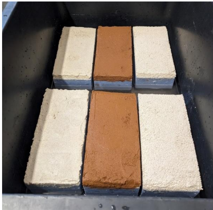
Joonis 3.13 Veevanni asetatud silikaattellised ja keraamilised tellised koos peale kantud krohvidega: vasakul Saviukumaja lubikrohv, keskel Saviukumaja savikrohv ja paremal RestHunt termokrohv
