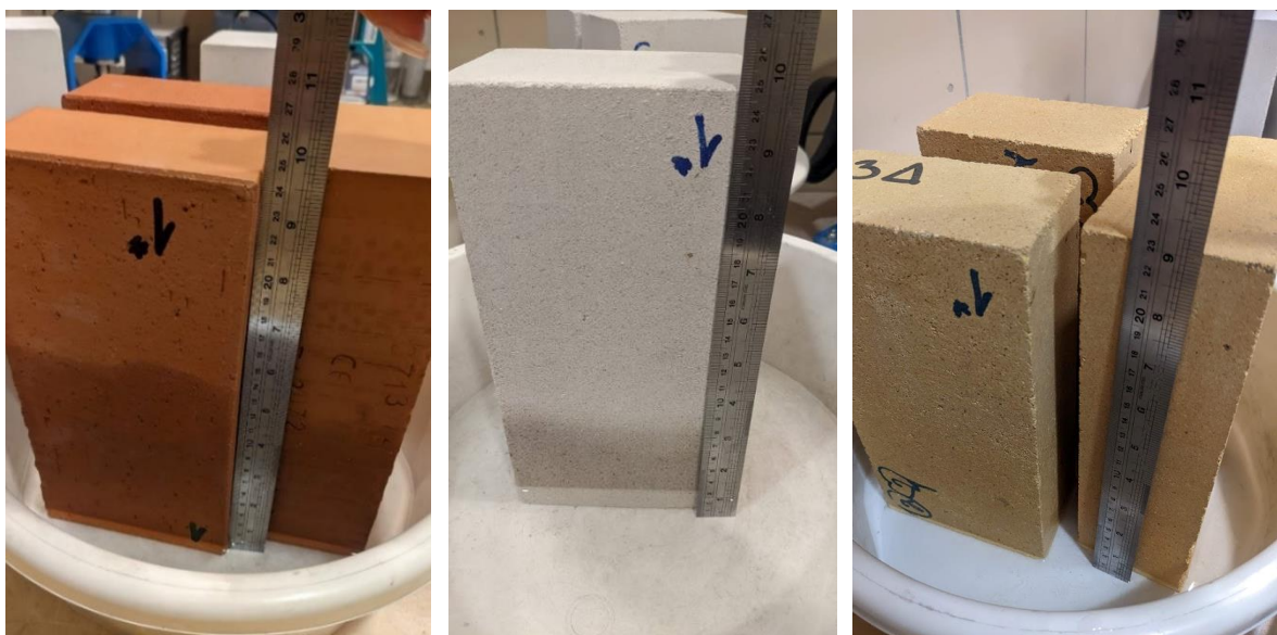
Joonis 3.1 Kraanivette kastetud keraamiliste telliste, silikaattelliste ja šamott-tellise kapillaartõusu mõõtmine
