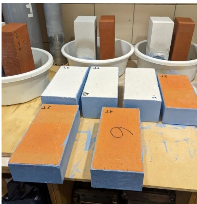
Joonis 3.7 Silikaattelliste ja keraamiliste telliste katmine hüdroisolatsiooniga
