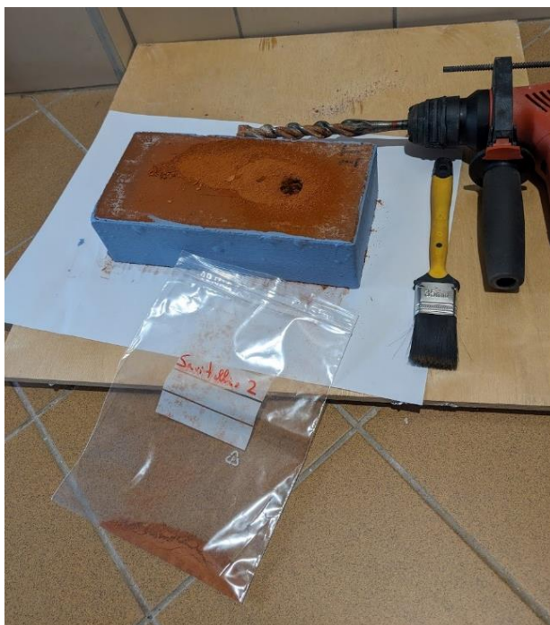
Joonis 3.8 Soolalahuses olnud keraamilise tellise lööktrelliga puurimine katseproovi valmistamiseks
