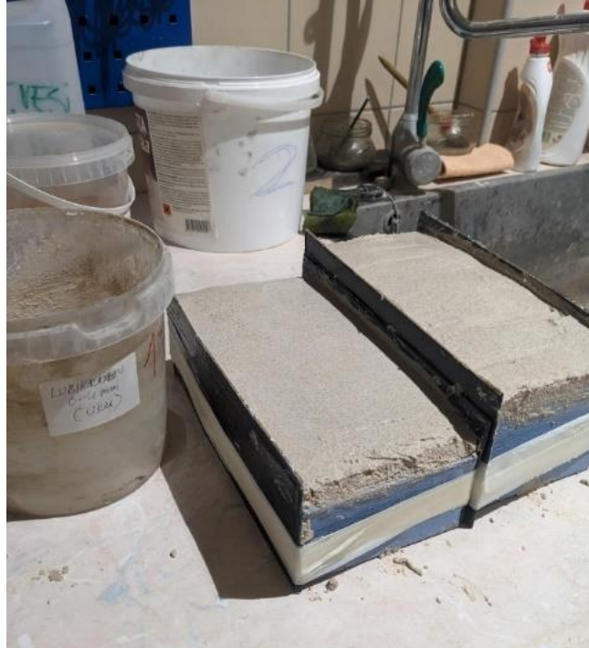
Joonis 3.12 Lubikrohvi pealekandmine silikaattellisele ja keraamilisele tellisele
