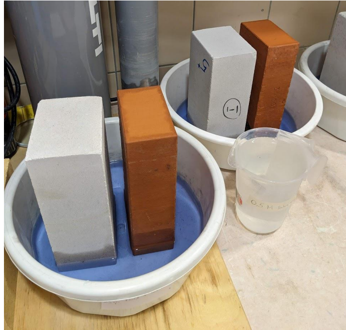
Joonis 3.4 Silikaattelliste ja keraamiliste telliste NaCl soolalahuse imavuse uurimine
