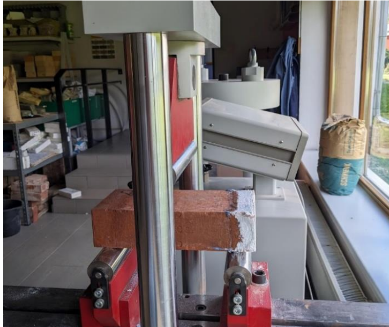
Joonis 3.6 NaCl soolalahuses olnud keraamilise tellise purustava paindejõu määramine Form-Testi katsemasinaga
