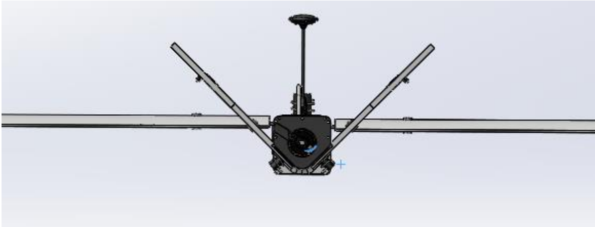
Joonis 4. V-kujuline tagatiiva disain.
