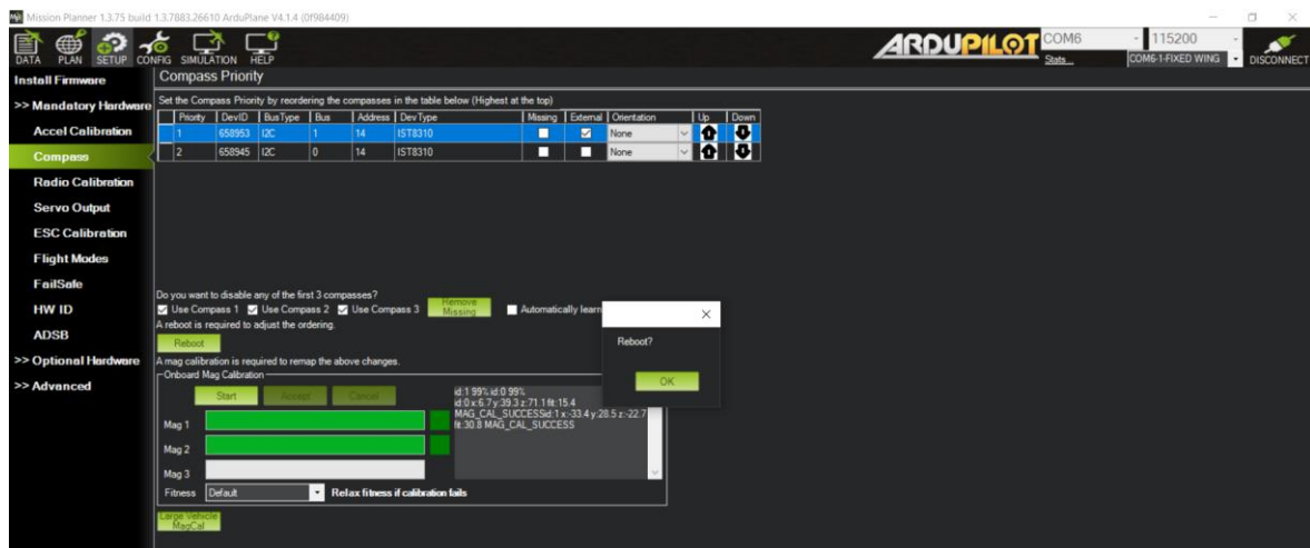
Joonis 16. Kompassi kalibreerimine Mission Planner tarkvaras.
