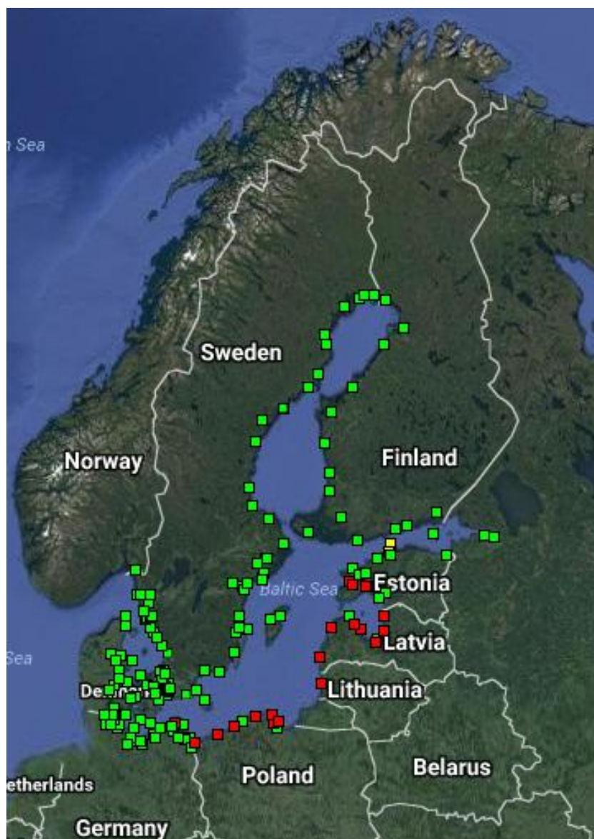
Joonis 1. BOOS süsteemi kuuluvad hoovusemõõtjad ja fikseeritud platvormid. Rohelise ja punase värviga on kujutatud hoovusemõõtjaid, kollase värviga fikseeritud mõõteplatvorme. (Baltic Operational ...)
