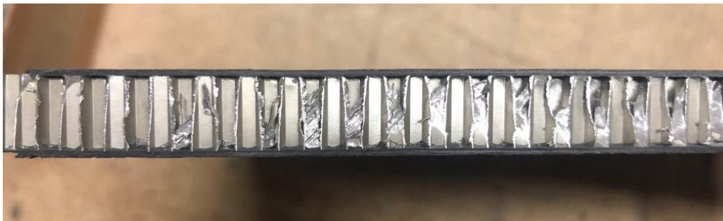
Sele 24 Lõplik laminaat pärast laminaadikihtide ja täitematerjali sidumist
