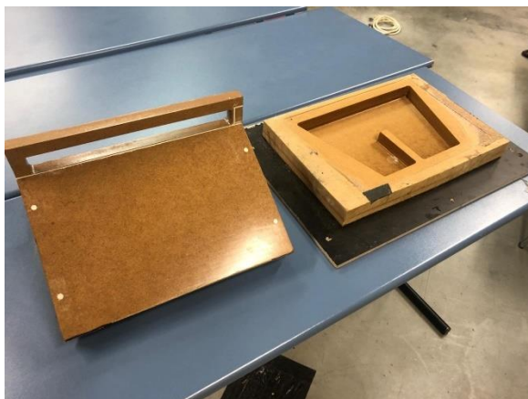
Sele 21 Elektroonikasektsiooni kaane ja õhukanali vormid
