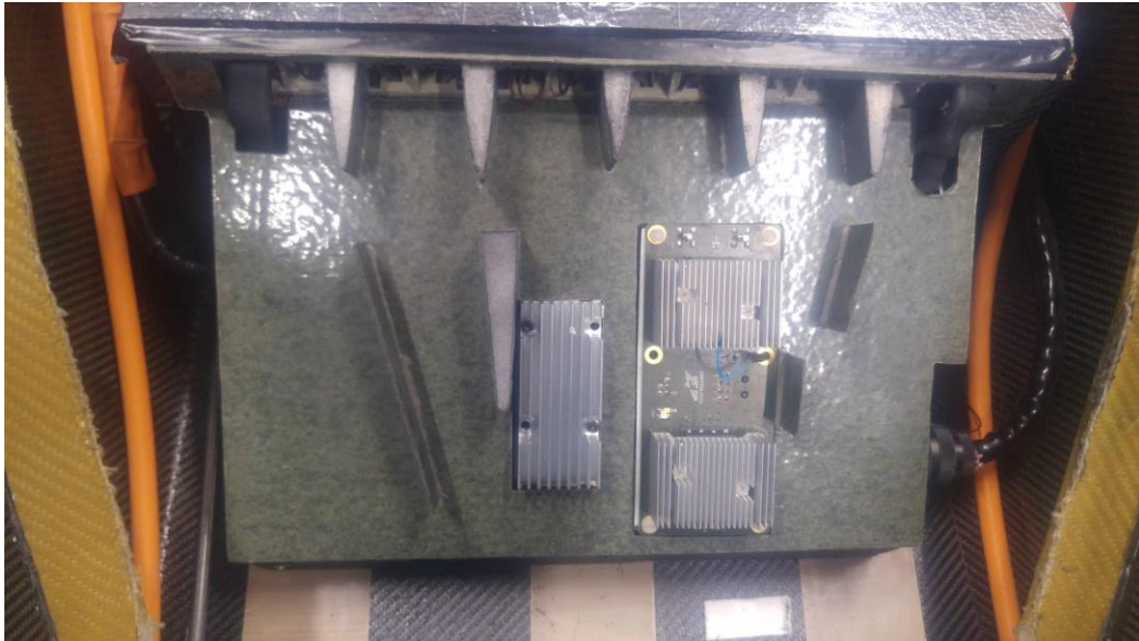
Sele 27 Akukasti elektroonikasektsiooni kaas õhusuunajatega (ilma kanalita)
