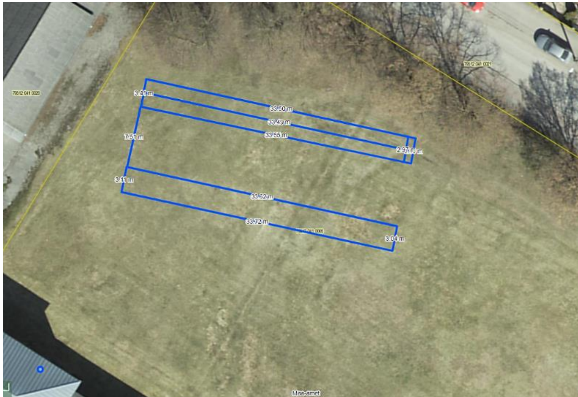
Joonis 3.3.1.6 Päikesepaneelide asetus muruplatsil (Bašev, 2019)
