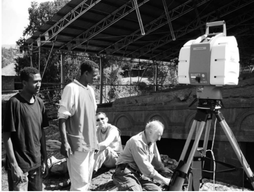
Joonis 1.2 Leica Geosystem laserskanner Aafrika kultuuripärandi mõõdistamisel [13]
