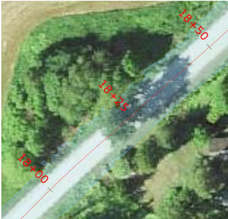
Joonis 3.9 Puust tekkinud punktipilve ebakorrapärane äär [autori erakogu]
