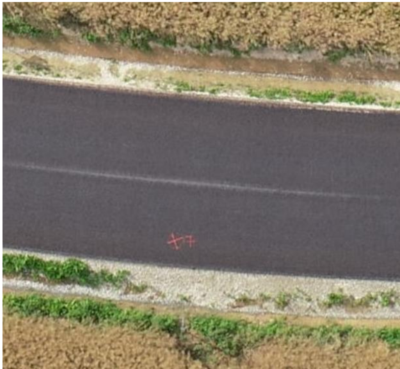
Joonis 3.5 GCP punktide märkimine maapinnale [Autori erakogu]
