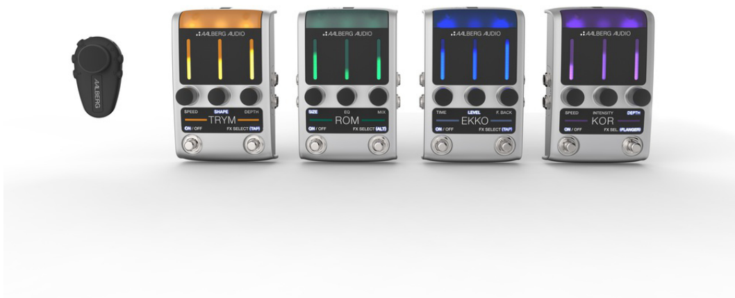
Joonis 3. Aalberg Audio AERO AE-1 kontrolleri ja pedaalid [25]
