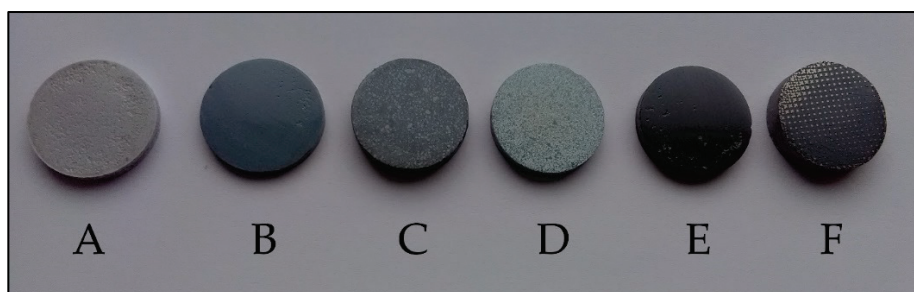
Figure 4.1 A) ZrO_2 , B) TiO_2 Anatase, C) 50% ZrO_2 and 50% TiO_2 , D) TiO_2 and 2.5% Ag, E) TiO_2 Rutile, F) TiO_2 embedded in Ti6Al4V lattice (diameter of samples is 20 mm and final heights are 3-6 mm after SPSing).
