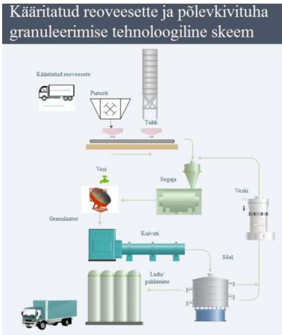
Joonis 1.2 Kääritatud reoveesete ja põlevkivituha granuleerimise tehnoloogiline skeem [16].
