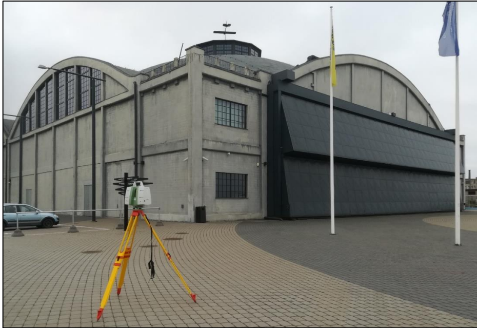
Joonis 4.1 Leica C10 laserskanner. Taustal Tallinna Lennusadam, fotol on nähtaval ka hoone nurgatorn, mille horisontaalsele katusele sai asetada laserskanneri
