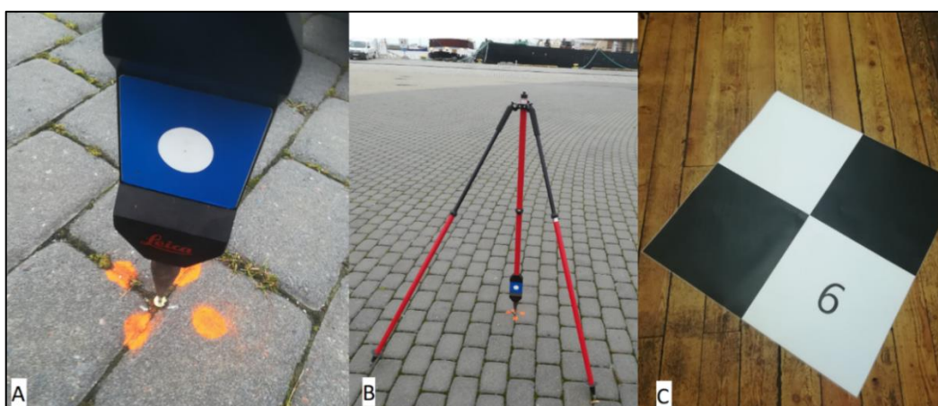
Joonis 4.4 Magistritöös kasutatud tähised. A pildil on kujutatud laserskaneerimise tähis tsentreerituna teravikuga asfaltinaela peale. Pildil B on kujutatud twin target it, mida hoiab loodis toed. UAV mõõdistamiseks kasutatud tähis, mõõtmega 1 * 1 m, on välja toodud pildil C
