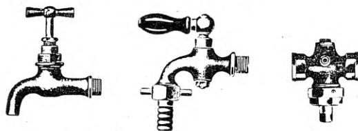
Joon. 68. Veeväljavoolukraan (vasakul), lõdvikumutriga veeväljavoolukraan (keskel), maakraan (paremal).
