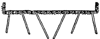
Joon. 256. Lõhkeaukude paigutus täisnurkse põikilõikega šahti ees.
