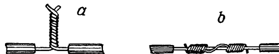
Joon. 196. Ajutised (lihtsustatud) ühendused: a — otste kokkukeeramise, b — otste keeramisega teineteise ümber.
