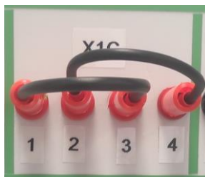
Рисунок 3.4 Подключение цепи STO с использованием перемычек
