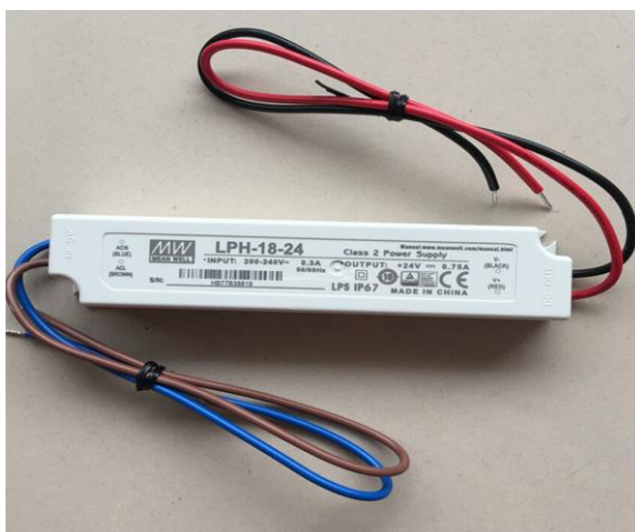
Рисунок 2.12 Блок питания 220 ACV/24DCV
