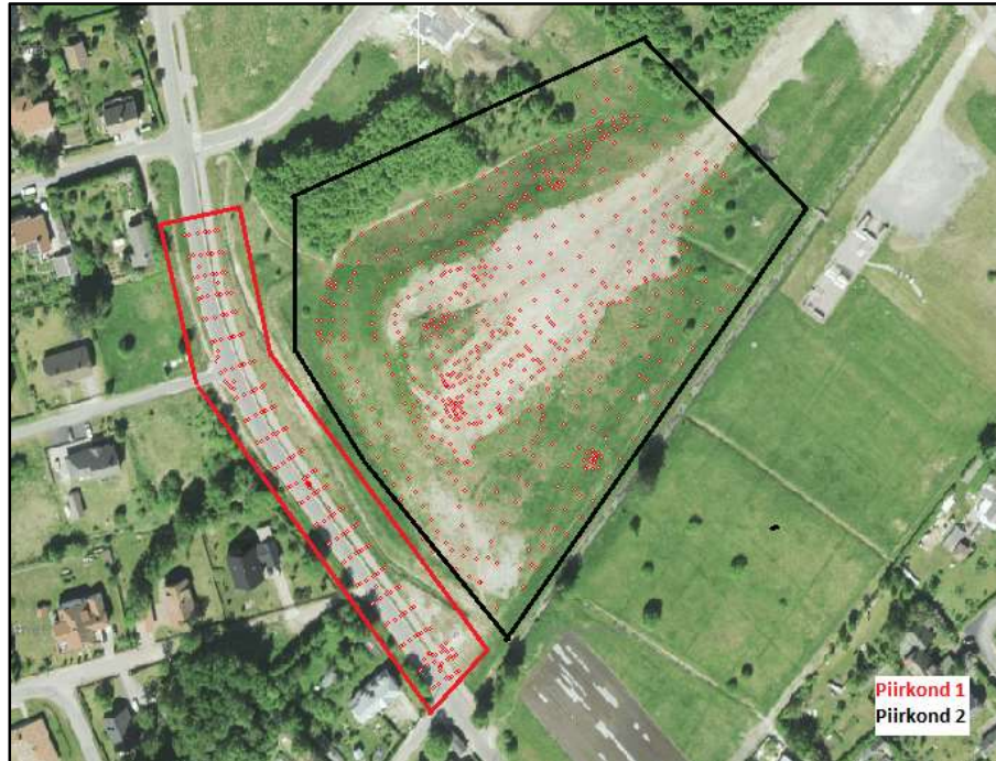
Joonis 5.4 Tahhümeetrilise mõõdistuspunktide (punasega) jaotus. Punane joon kirjeldab piirkonda 1, must joon kirjeldab piirkonda 2
