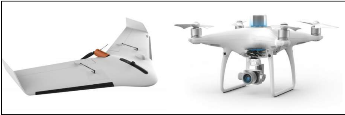
Joonis 1.2 Delair UX11 fikseeritud tiivaga droon (vasakul) ja DJI Phantom 4 RTK rootormootoriga droon (paremal) [6]
