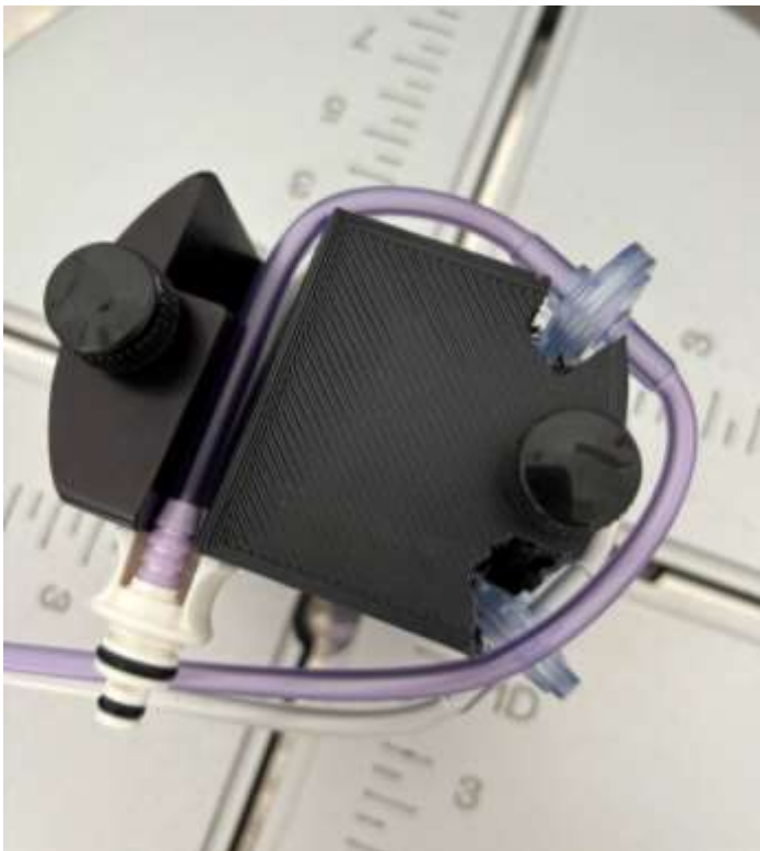
Sele 5.4.2.4 Lõigatud filtri soontega protorüüp
