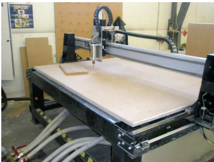
Joonis 6.2. Ettevõttes xyz kasutatav 3-teljeline CNC pink
