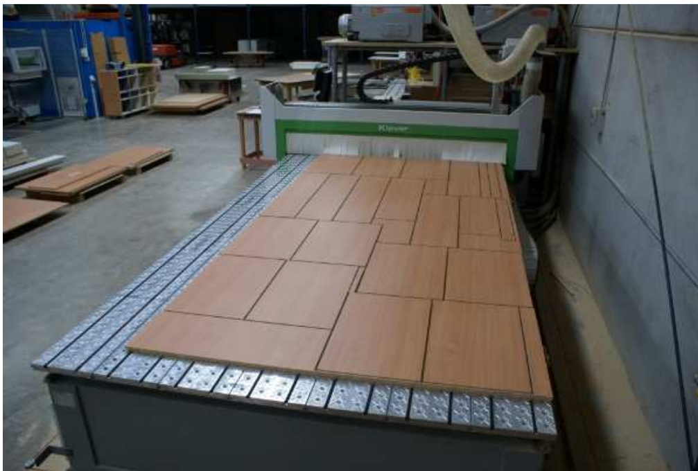
Joonis 5.4. CNC formaatsaag ja selle töö tulem [53]
