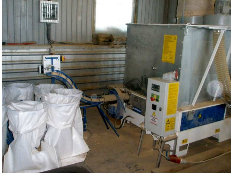
Joonis 4.3. Ettevõttes xyz kasutatav briketipress.
