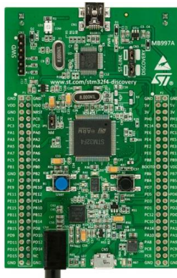
Joonis 3 STM32 samm-mootori mikrokontroller
