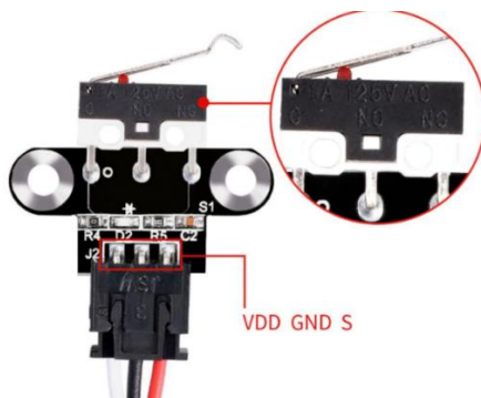
Joonis 4 Samm-mootori käigu mehaaniline tõkis
