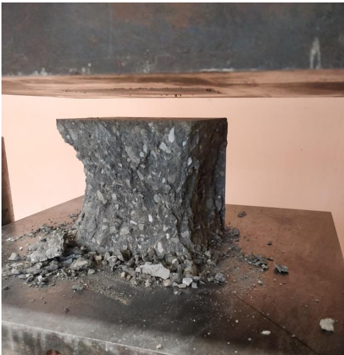
Joonis 3.6 Katsekeha T2-4 (betoon C25/30 XC2 lisandita) purunemispilt
