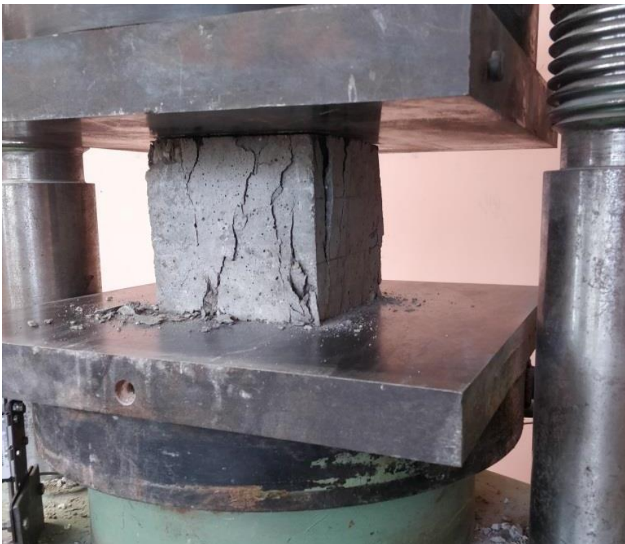
Joonis 4.6 Katsekeha T2-14 (betoon C30/37 XC2 lisandita) purunemispilt
