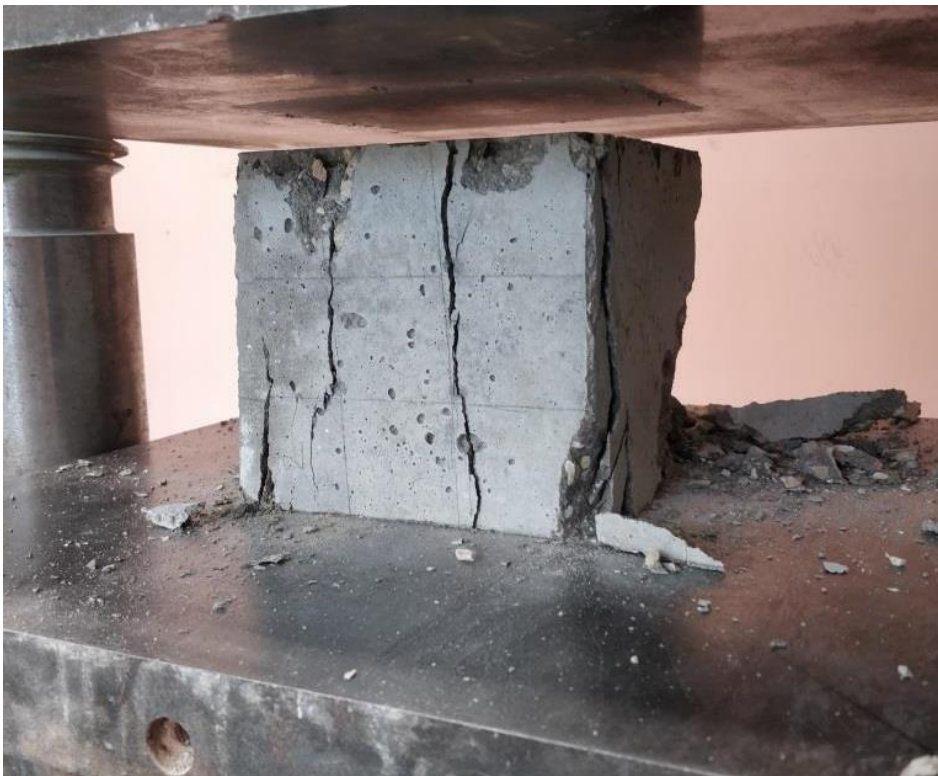
Joonis 4.12 Katsekeha L2-19 (betoon C30/37 XC2 lisandiga) purunemispilt
