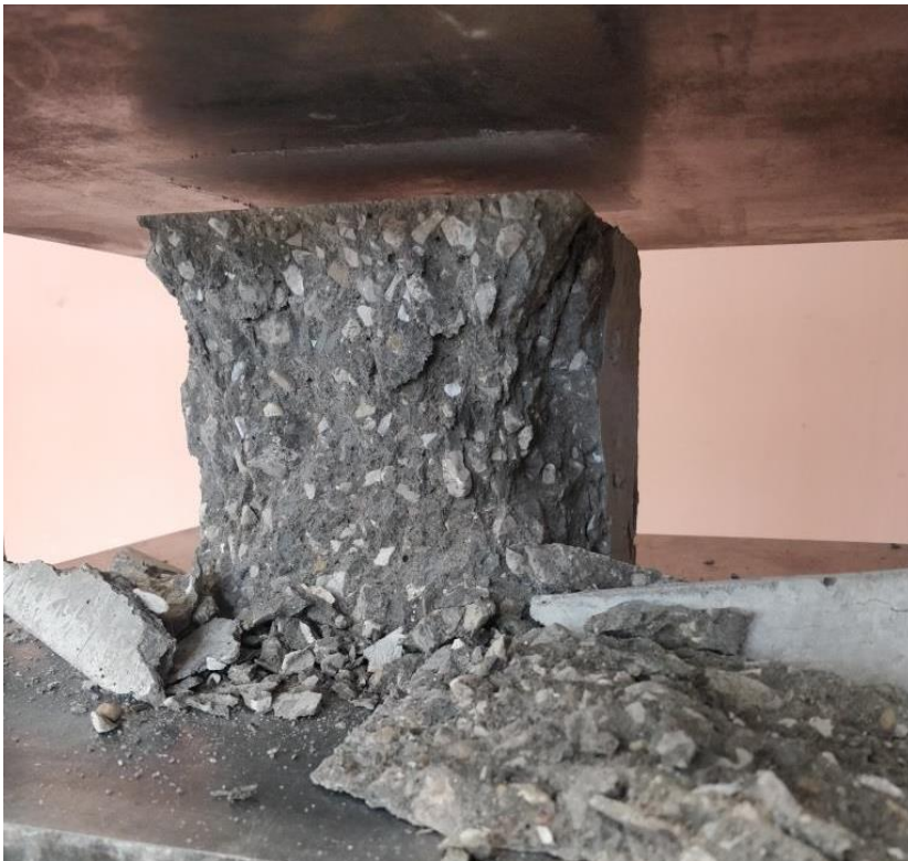
Joonis 3.12 Katsekeha L2-15 (betoon C25/30 XC2 lisandiga) purunemispilt
