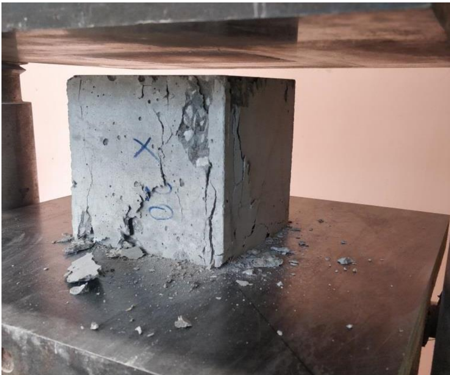
Joonis 3.14 Katsekeha L3-20 (betoon C25/30 XC2 lisandiga) purunemispilt
