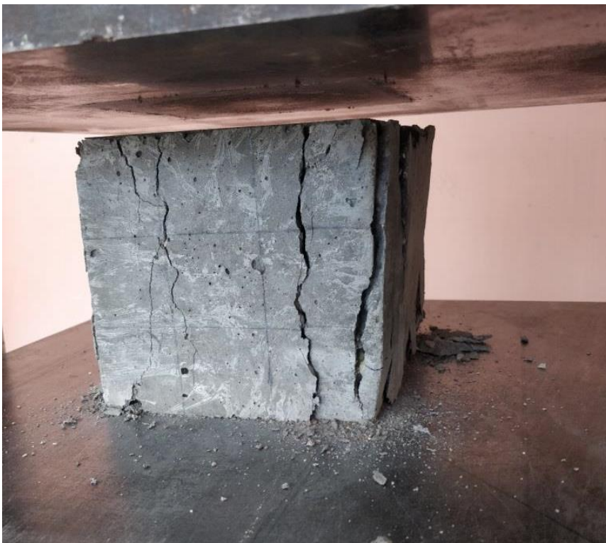
Joonis 4.4 Katsekeha T1-12 (betoon C30/37 XC2 lisandita) purunemispilt
