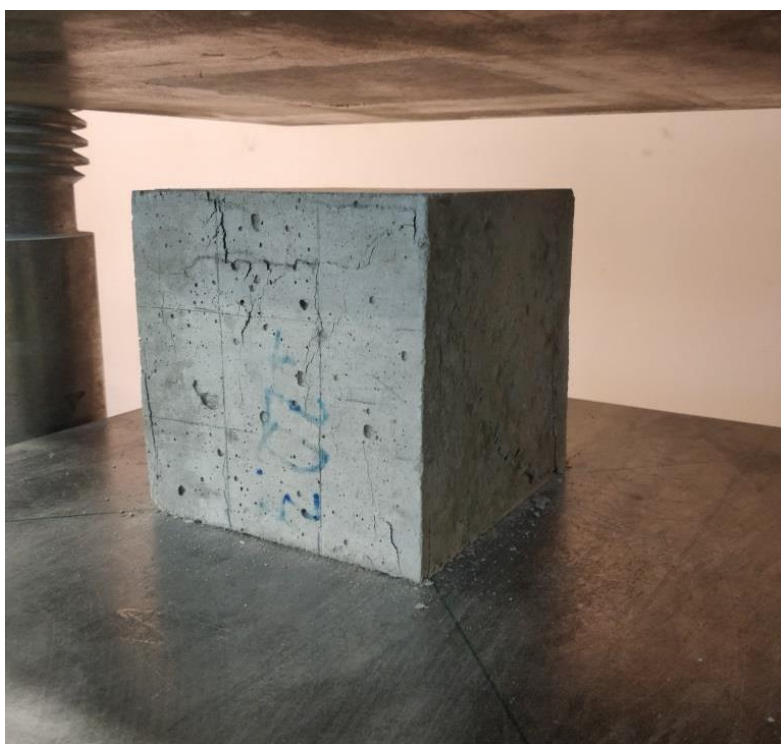
Joonis 3.2 Katsekeha T0-3 (betoon C25/30 XC2 lisandita) purunemispilt
