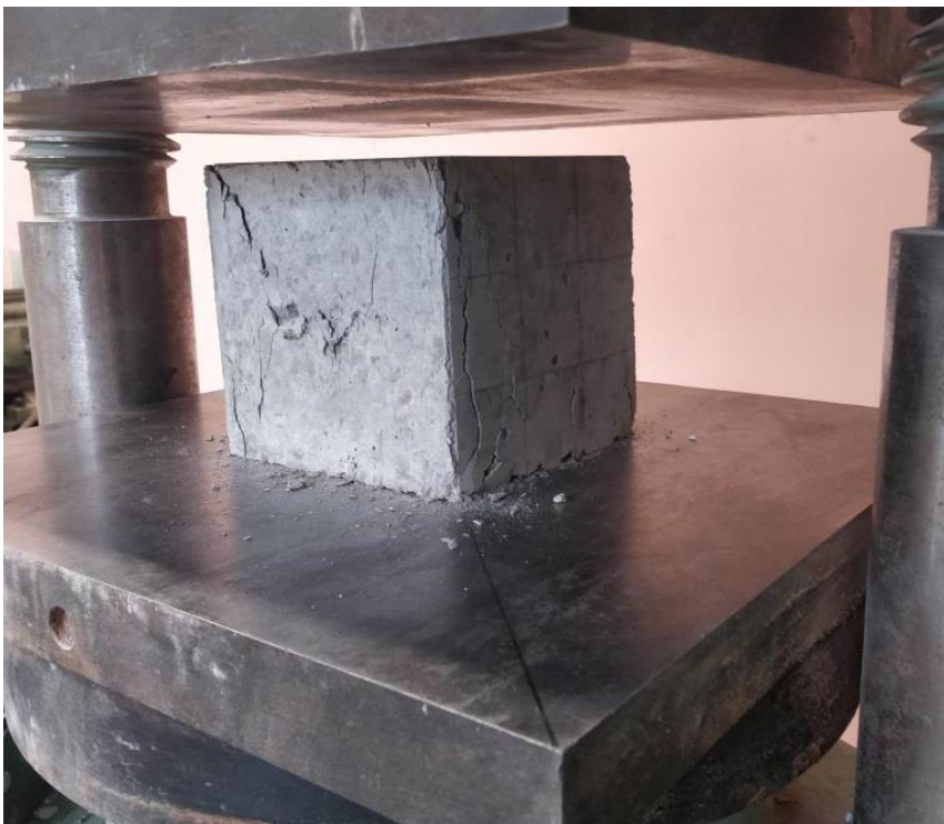
Joonis 3.10 Katsekeha L1-18 (betoon C25/30 XC2 lisandiga) purunemispilt
