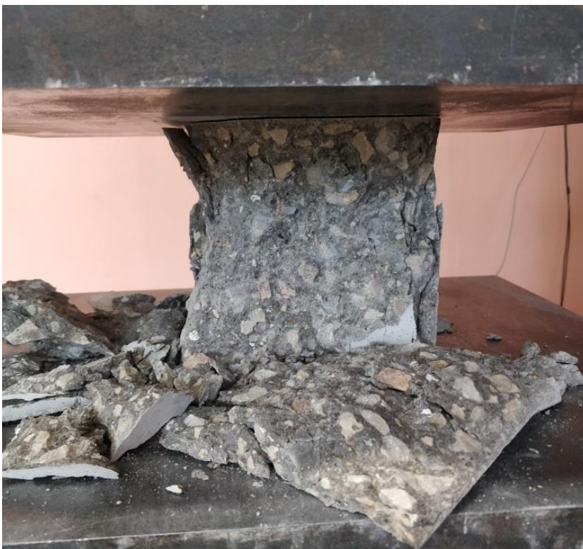
Joonis 4.8 Katsekeha T3-4 (betoon C30/37 XC2 lisandita) purunemispilt
