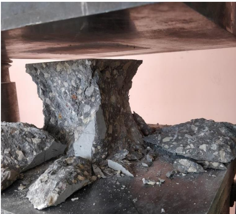
Joonis 4.10 Katsekeha L1-16 (betoon C30/37 XC2 lisandiga) purunemispilt
