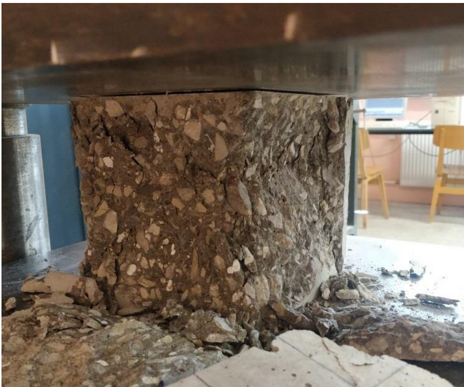
Joonis 3.8 Katsekeha T3-7 (betoon C25/30 XC2 lisandita) purunemispilt
