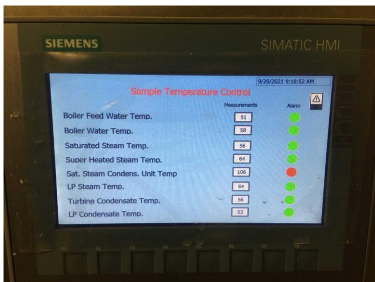
Joon. 3.7 Siemens ktp700 basic DP (6AV2 123-2GA03-0AX0).
