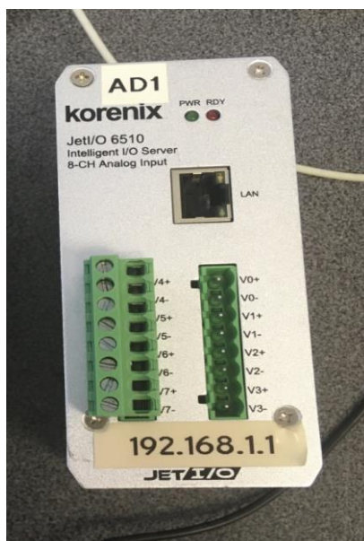
Joon. 2.3 Korenix jet I/O 6510 8-CH Analog Input
