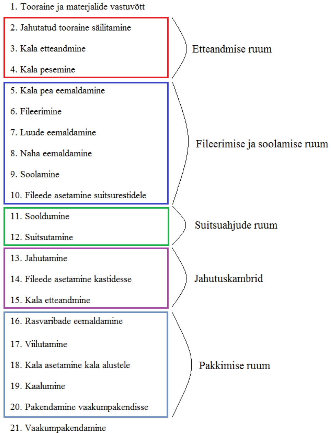
Joonis 5 Külmsuitsu lõhefilee tootmise tehnoloogiline skeem
