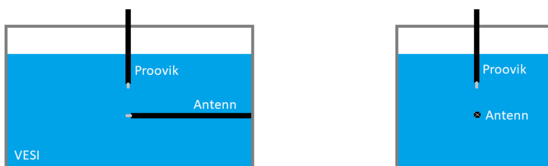
Skeem 2. Prooviku ja antenni asend üksteise suhtes eest ja paremalt vaadates esimesel katsel
