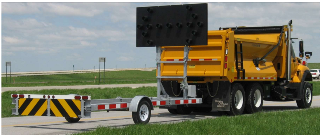
Joonis 3.4 TTMA-100 treiler veoki taga tööasendis valguspaneeliga [3]
