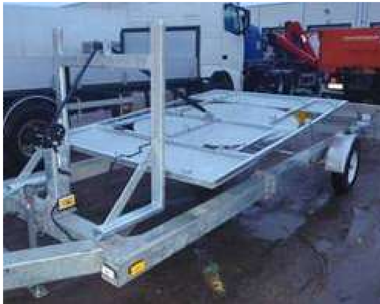
Joonis 4.3 TTMA langetatava pealisehitusega [2]
