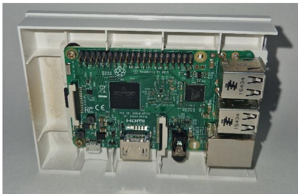
Joonis 10. Raspberry Pi 3B, kus on paigaldatud Home Assistant OS server
