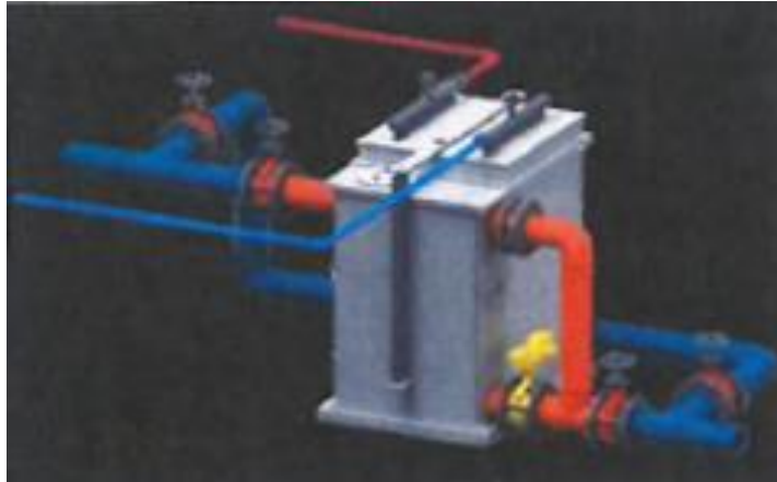
Joonis 4.4 Polarsol heitvee soojustagastussüsteemi üksik ühendusviis [35]
