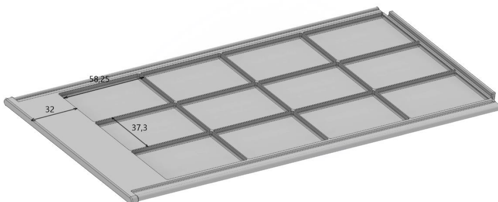
Joonis 7.18 Küljepaneelide süvistused ja jäikusribid
