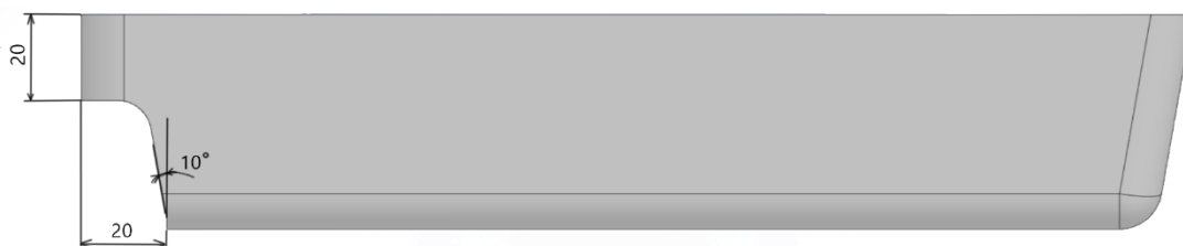
Joonis 7.3 Sahtli käepideme mõõtmestamine
