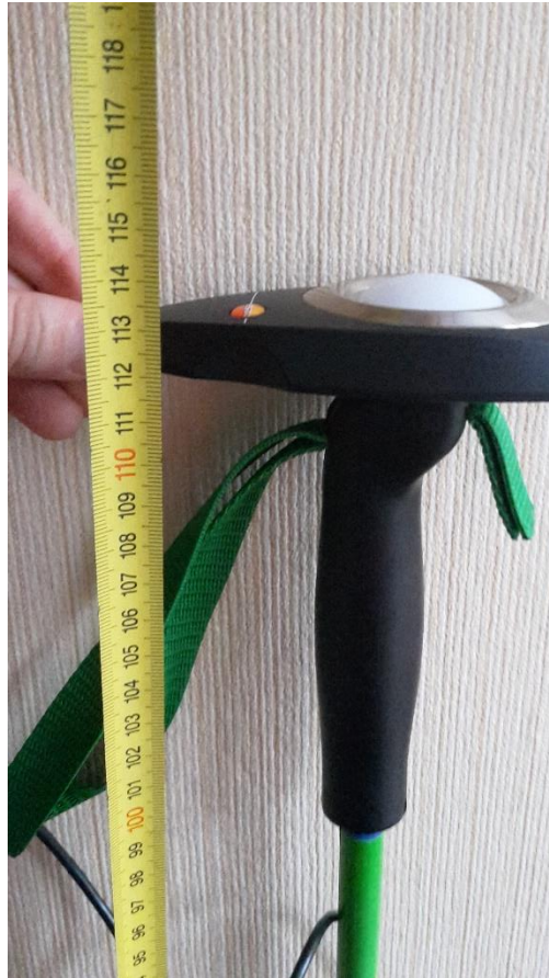
Joonis 4. Luksmeeter Testo 545 valgussensori kinnitus kõndimiskepil
