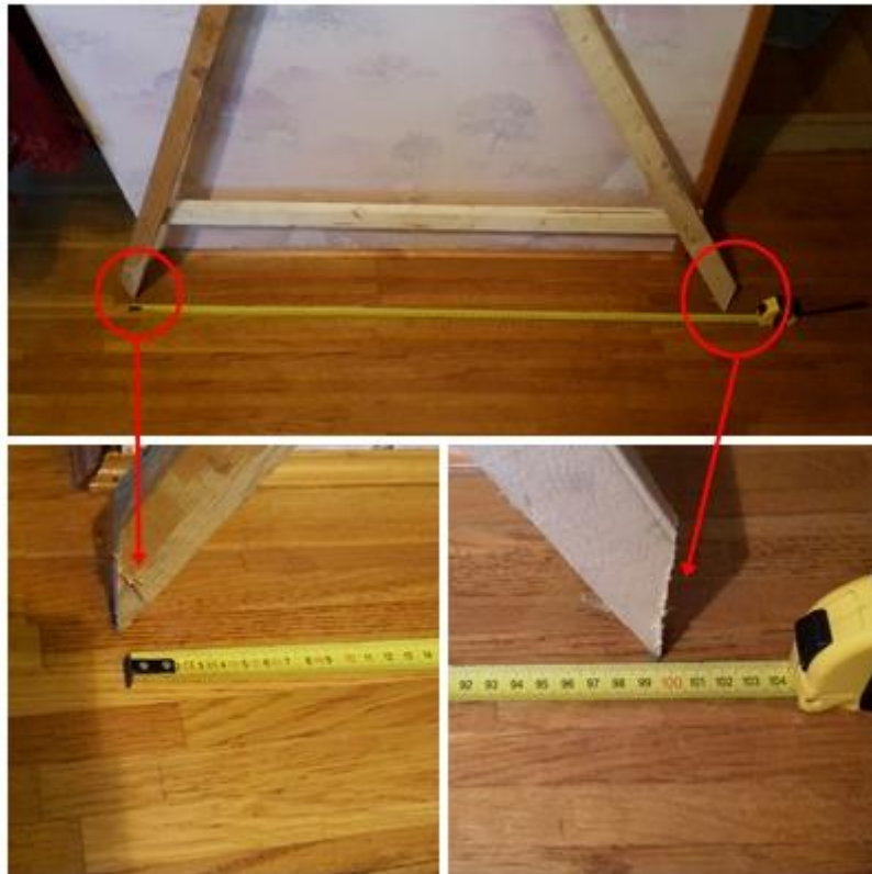
Joonis 5. Ühemeetrise sammuga "A-täht", millega tagatakse luksmeetriga teostatud mõõtmiste konstantne ja kindel vahemaa üksteisest
