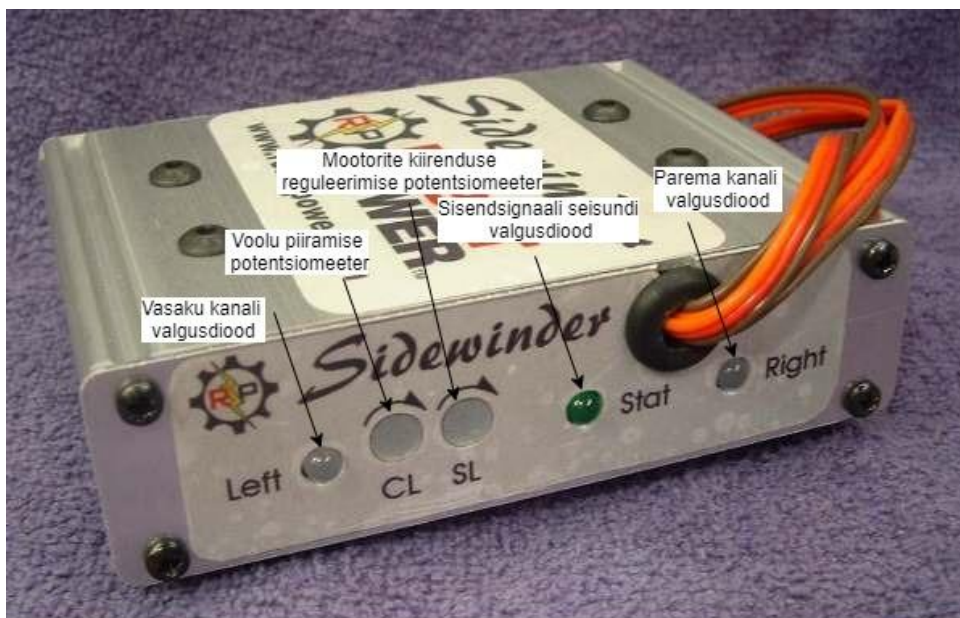
Joonis 2.2 Robot Power Sidewinder kiirusregulaatori esipaneel [9]
