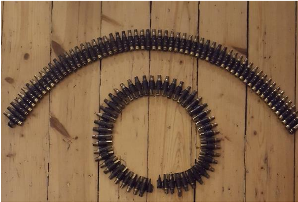
Sele 3.3 Moonalintide M13 (üleval) ja korduvkasutatava (alumine) painderaadiused
