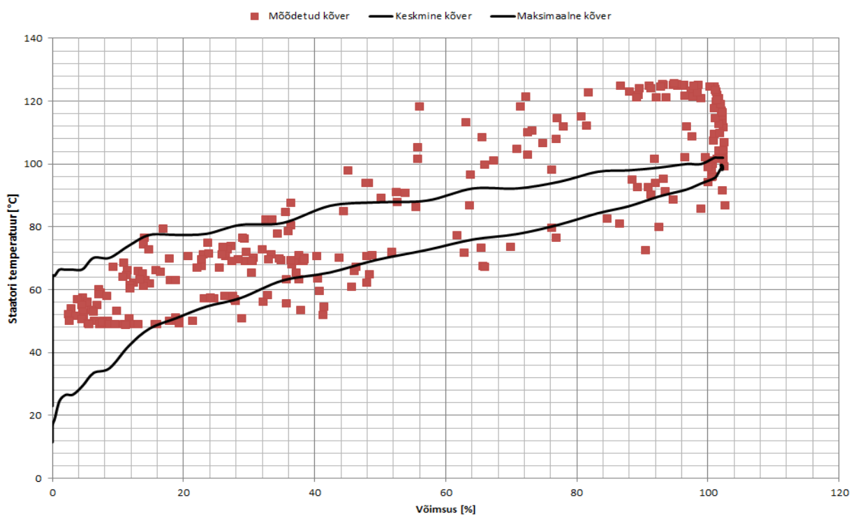
Joonis 3.24 Staatori temperatuuri muutumise võrdlemine erineval väljundvõimsusel näitab normaalsetest piiridest väljumist.
