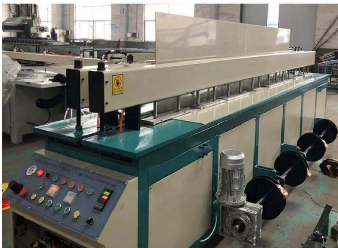
Joonis 21. Plaatide ühendamiseks mõeldud kuuma plaadiga põkk-keevituse masin
