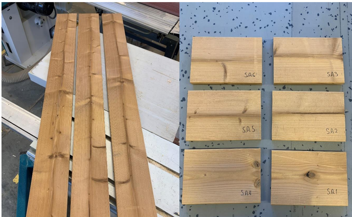
Joonis 2.4. Vasakul lõikamata kuuse lauad, paremal valmis saetud ning nummerdatud kuuse katsekehad.
