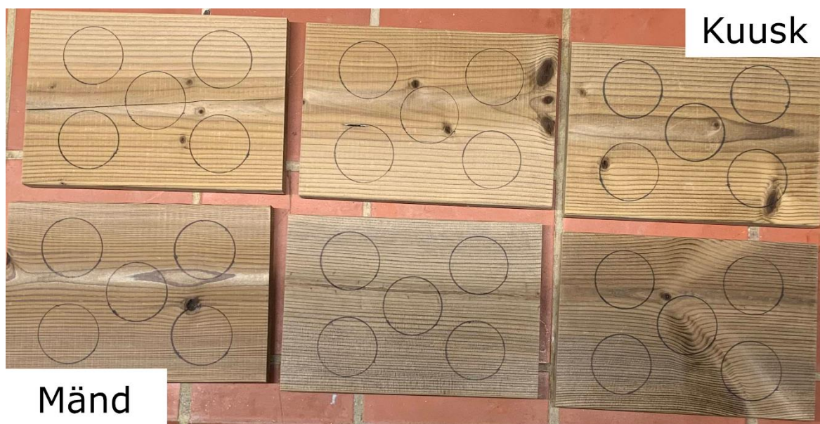
Joonis 3.11. KOH lahusega kaetud katsekehade lõplik tulemus peale keemilist töötlust ning kahte nädalat UV-kambris olekut.
