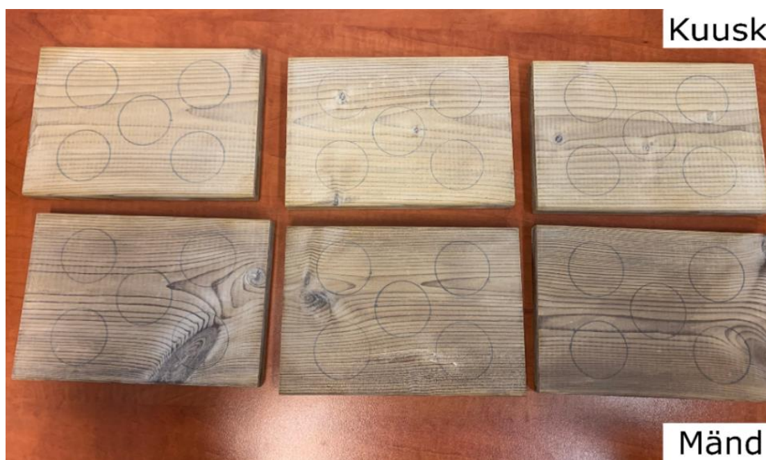
Joonis 3.2. Katsekehad peale NaOH lahusega keemilist töötlust ja kuivatust.
