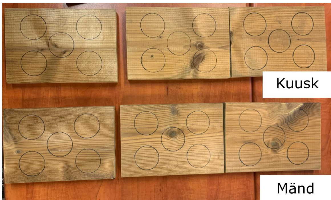
Joonis 3.10. FeSO 4 lahusega kaetud katsekehade lõplik tulemus peale keemilist töötlust ning kahte nädalat UV-kambris olekut.
