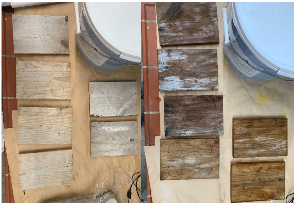
Joonis 3.1. Vasakul NaOH lahusega kaetud katsekehadele tekkinud ja maha pesemist vajav soolakiht, paremal neutraliseeritud katsekehad (katsekehadele tekkis rõn soolakiht uuesti tagasi ning tuli taas neutraliseerida).
