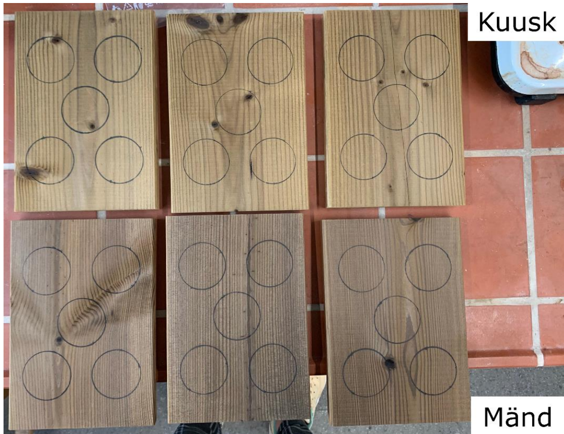
Joonis 3.4. Katsekehad peale NaOH lahusega keemilist töötlust ja kuivatust.
