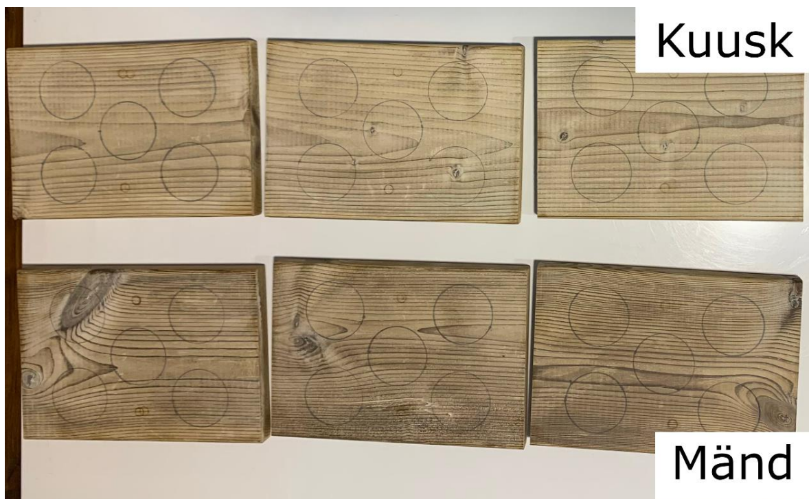
Joonis 3.9. NaOH lahusega kaetud katsekehade lõplik tulemus peale keemilist töötlust ning kahte nädalat UV-kambris olekut.
