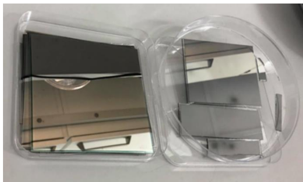
Joonis 2.4 Alusele sadestatud kiled, vasakul on alusel vaid Mo kile ning paremal koos \text{CuSbSe}_2 absorbermaterjaliga (Mo puhul on kile väga peegelduv, \text{CuSbSe}_2 puhul tuhmim)
