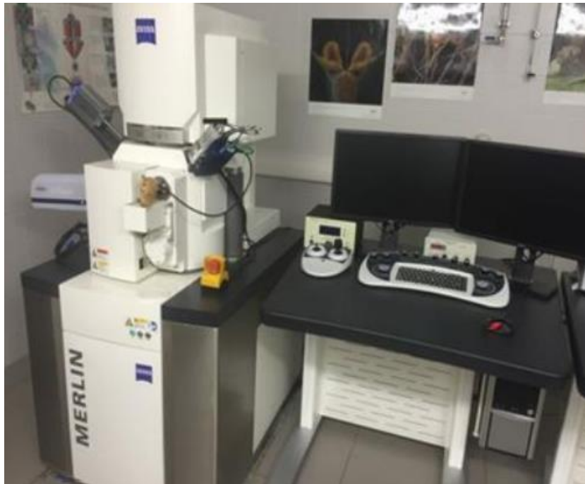
Joonis 2.9 Uurimistöös kasutatav skaneeriv elektronmikroskoop Zeiss Merlin [35]
