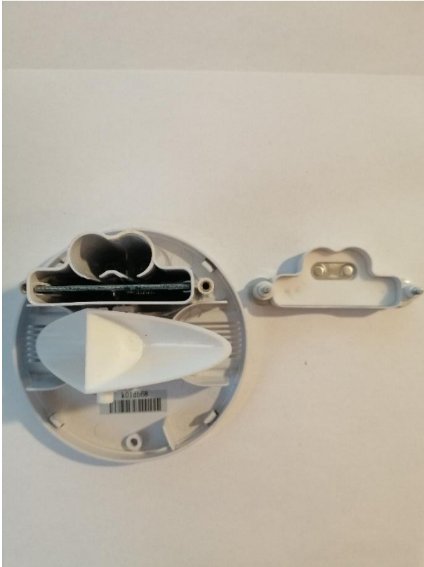
Joonis 1.4: Netatmo NWS02RG sisu mõõte ja toitesüsteem
