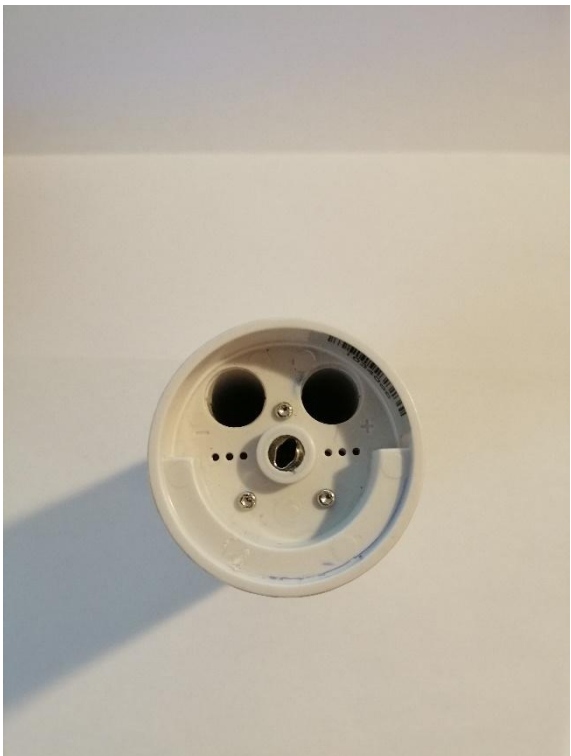
Joonis 1.2: Netatmo NWS01OUT põhjavaade ilma kaaneta
