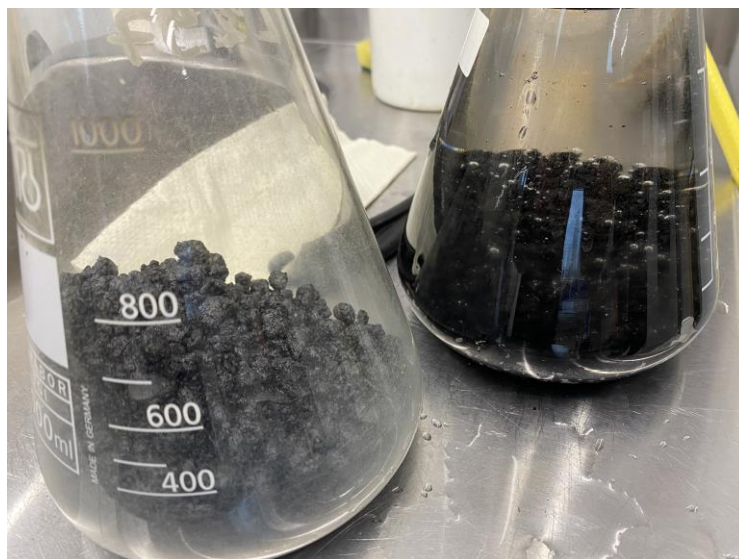
Joonis 4.4 Püknomeetri täitmine õhuvaba veega
