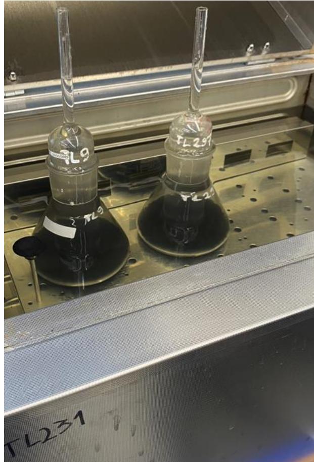
Joonis 4.6 Püknomeeter täidetud demineraliseeritud veega
