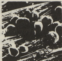
Фиг. 2. Кристаллы \text{CdS} , полученные в присутствии плавня \text{CdCl}_2 . Температура кристаллизации 700^\circ\text{C} , продолжительность кристаллизации 3 часа. (Увеличение 150 х).
