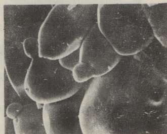
Фиг. 6. Кристаллы \text{CdS} , полученные в присутствии плавня \text{NaCl} . Температура кристаллизации 950^{\circ}\text{C} , продолжительность кристаллизации 3 часа. (Увеличение 650 х).
