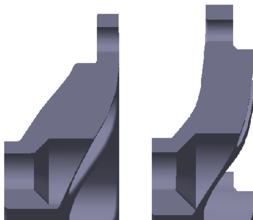
Sele 5.21. Vana (vasakul) ja uue (paremal) veljetsentri kodarate lõige
