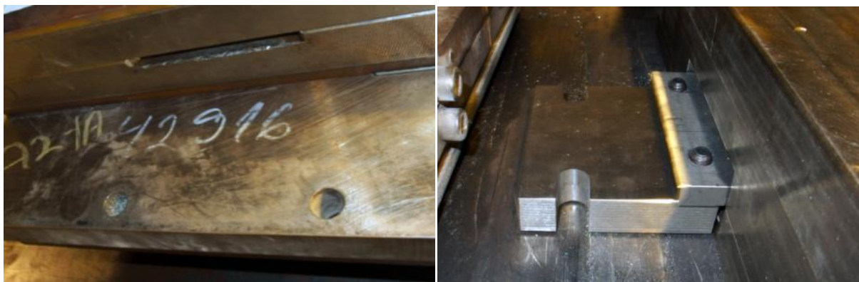
Sele 4.14. Vormi kinnitused enne (vasakul) ja pärast (paremal) SMED-i
