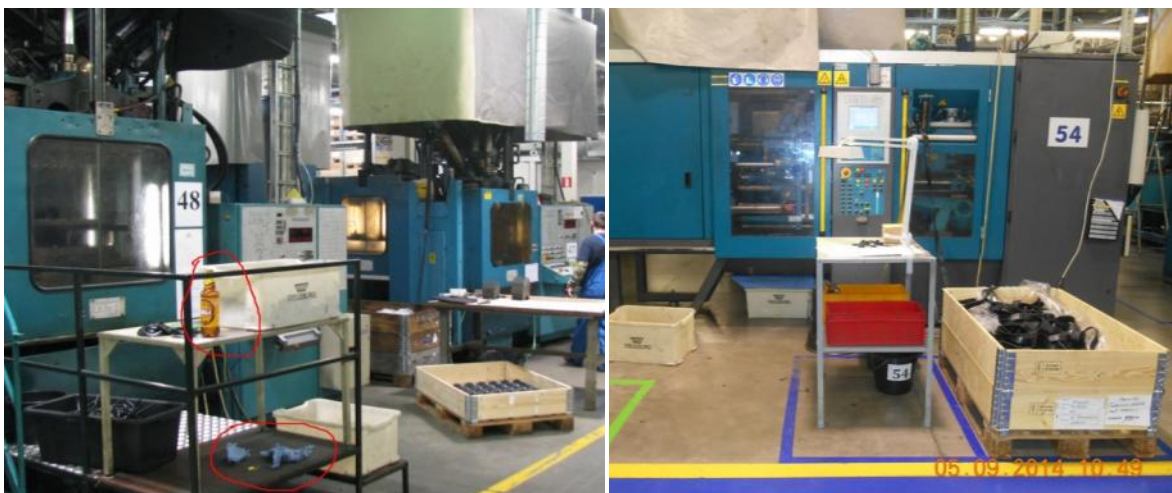
Sele 3.2. Töökoht enne (vasakul) ja pärast (paremal) 5S-i juurutamist.
