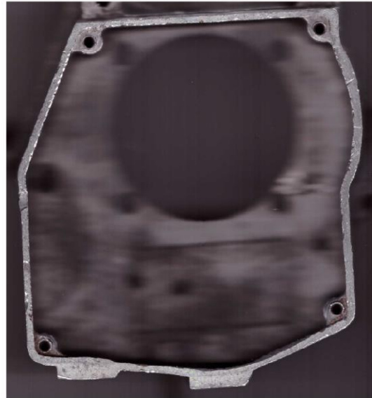
Sele 2.5 Karterseina tugevdusplaat, vasakul CAD detail ja paremal skännitud detail
