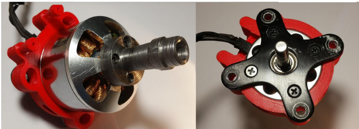
Sele 2.4 Halli anduri adapteri kinnitus elektrimootoriga
