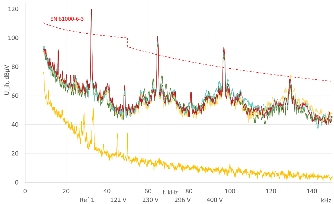
Joonis 5.5. Vaheldi 9 kHz – 150 kHz sagedusribas juhtivuslike emissioonide sõltuvus vaheldi alalisvoolu sisendpingest. Ref 1 tähistab häiringute baastaset ilma katsetatava vaheldita mõõtmisel.
