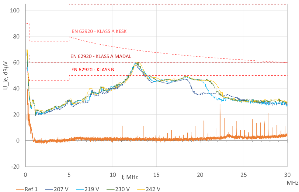
Joonis 5.8. Vaheldi 150 kHz – 30 MHz sagedusriba juhtivuslike emissioonide sõltuvus vaheldi vahelduvvoolu väljundpingest.
