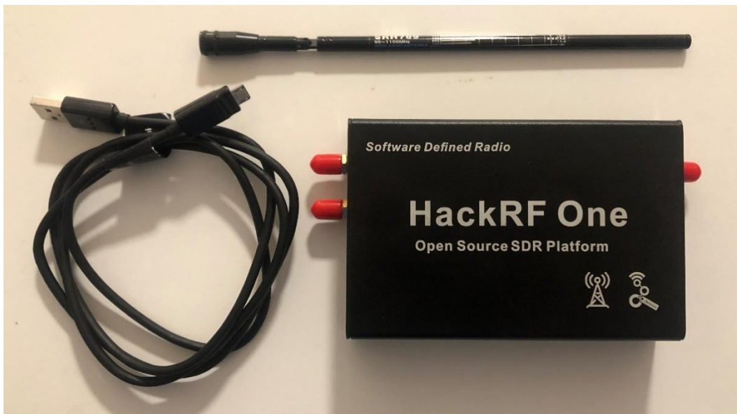
Joonis 2 Tarkvararaadio komplekt (tarkvararaadio, antenn ja arvutiga ühendamise juhe)
