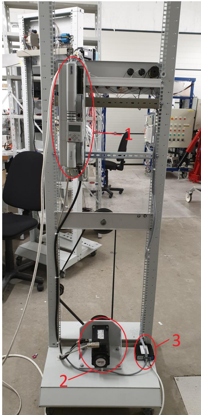
Joonis 2.17 Katsepinki lõpliku konstruktsiooni tagavaade. 1 – sagedusmuundur, 2 – servomootor, 3 – pingemuundur
