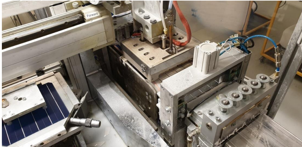
Joonis 1.9 Jootmismasina erinevad osad liiguvad sünkroonselt töö tegemisel [11]
