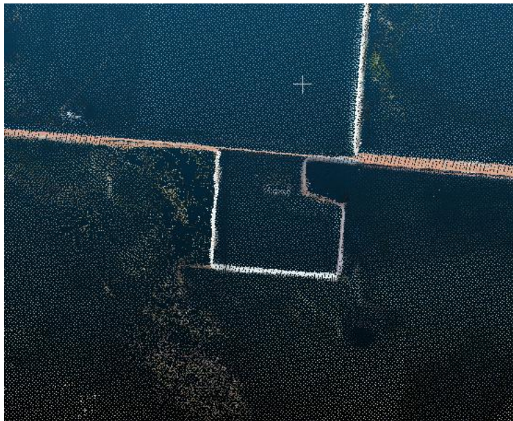
Joonis 6.5 Kuvatõmmis CloudCompare tarkvarast. Silikaattelistest hoone aerofotogrammeetrilisel teel loodud punktipilvel
