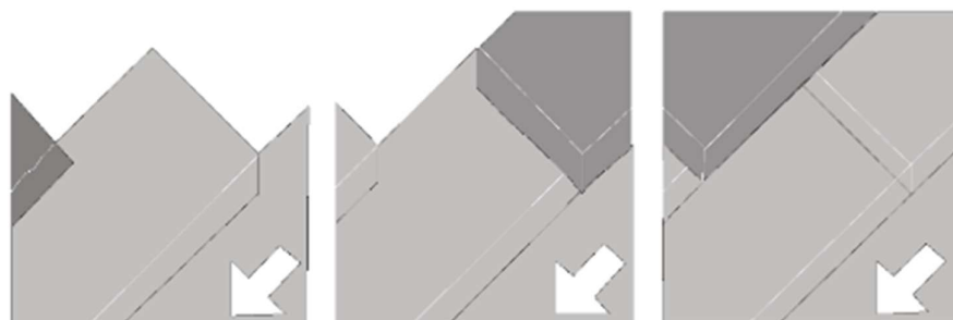
Joonis 5.2 Bituumenrullmaterjali nurkade tagasilõiked [25]
