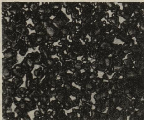
Фиг. 5. Микроструктура образца TiC-20Ni-20Mo. Травление щелочным раствором железосинеродистого калия, увеличение 2000 х.
